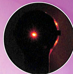
背面のLEDランプで 後方からも点灯確認
