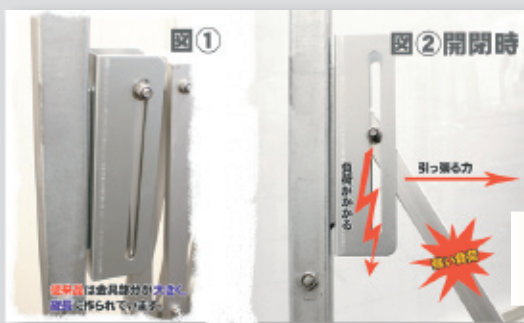
図2のように開閉時に引っ張る力と金具部分の矢印（力の加わり方）が違うためクロス材（柱）に強い負荷がかかり折れてしまうことが多い。
